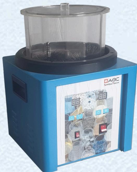
Les centrifugeuses magnétiques sont constituées d'un bâti à l'intérieur duquel un plateau magnétique horizontal est mis en rotation.
