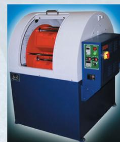
La centrifugeuse satellitaire présente l'intérêt de réduire sensiblement les temps de cycle, en particulier pour l'étape 1.
