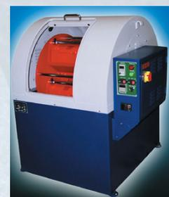
La centrifugeuse satellitaire présente l'intérêt de réduire sensiblement le temps de cycle de l'étape 1.
