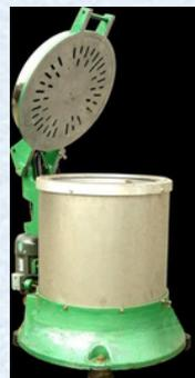
Ces équipements permettent le séchage des pièces par la combinaison d'un mouvement centrifuge et d'un soufflage d'air chaud.
