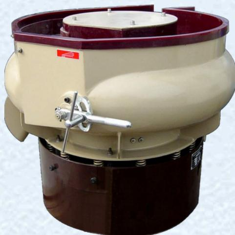
Les vibrateurs circulaires sont des équipements de tribofinition utilisés pour les opérations d'ébavurage et de polissage en vrac.
