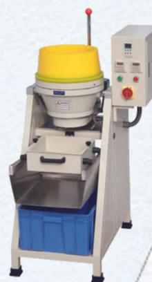
Pendant le traitement, les pièces subissent un mouvement de type toroïdal, du fait du mouvement rotatif du plateau.
