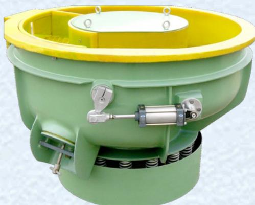
Les vibrateurs circulaires sont des équipements de tribofinition utilisés pour les opérations d'ébavurage et de polissage en vrac.
