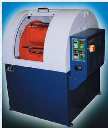
La centrifugeuse satellitaire présente l'intérêt d'éviter le polissage manuel (réduction du temps-opérateur et des troubles musculo-squelettiques TMS) et de garantir une parfaite reproductibilité du polissage et des arrondis d'arêtes.
